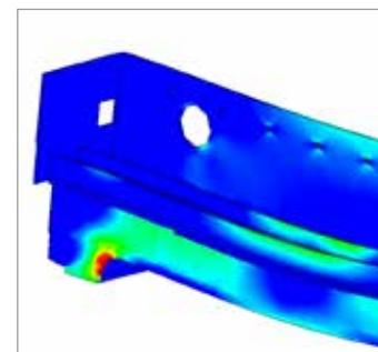
**Le banc et les supports de la poutre sont constitués d'une structure en acier monobloc électrosoudé de grande épaisseur et ont été étudiés, par des méthodes de calcul par éléments finis (MEF), pour mieux répondre aux sollicitations mécaniques auxquelles ils sont soumis.**
