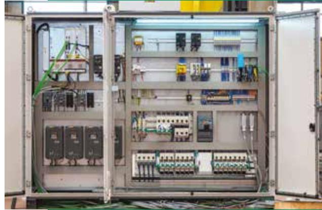
Le système électrique/électronique a été conçu et construit en adoptant un système FIELD BUS, résultant en une simplification du câblage, en garantissant une diminution de la possibilité de pannes et, éventuellement, une recherche plus rapide et plus opportune de celles-ci.
